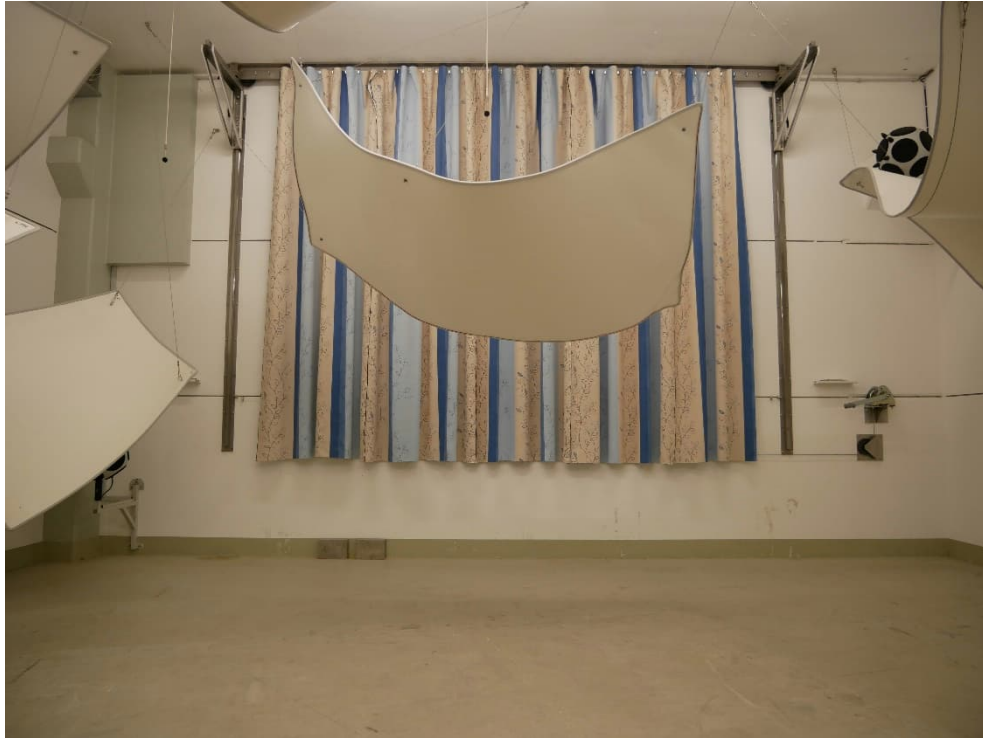
Abbildung B.1. Prüfanordnung im Hallraum (frontale Ansicht).
