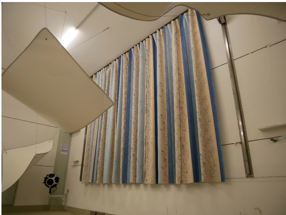
Abbildung B.2. Prüfanordnung im Hallraum (diagonale Ansicht).
